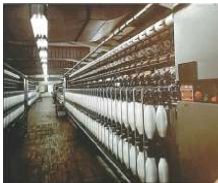
Slika 2: Stroj za kodranje (teksturiranje) umetnih filamentov npr. poliamidnih, poliestrskih.
